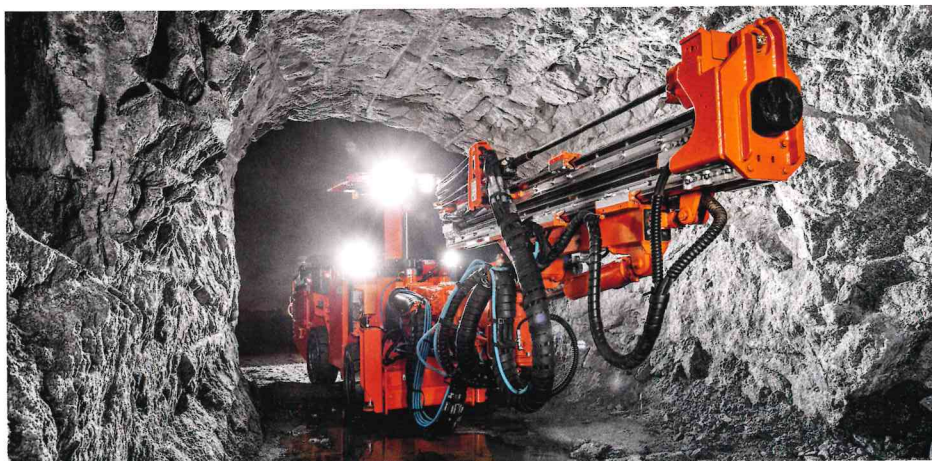
Optimale Lösung für das Bohren in engen Gängen: Der neue DD212 bietet unter anderem eine präzise elektronische Positionierung, einen ergonomischen Bedienerstand und Datenüberwachung.
